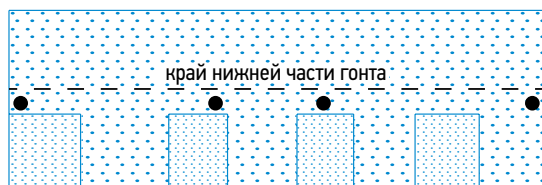
Уклон кровли менее 60°
